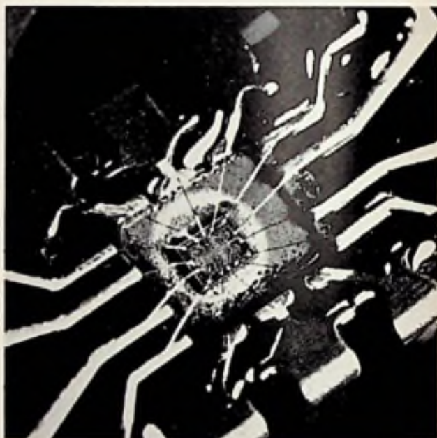
Afb. 9. Geïntegreerde schakeling gemonteerd in een DIL. Duidelijk zijn de gouddraadjes, die de verbinding tussen het IC en de pennen vormen, zichtbaar.
